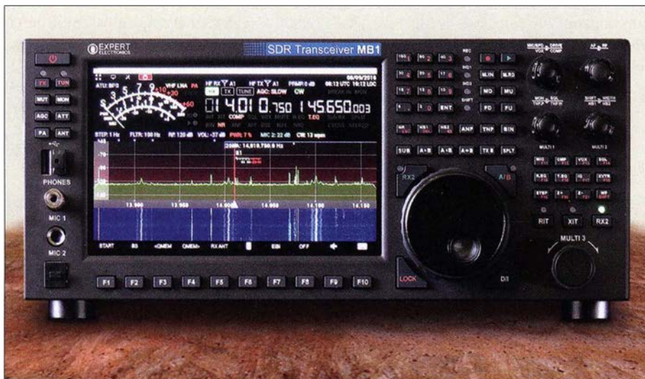
Bild 1: An der Frontseite des MB1 fallen eine Vielzahl von Tasten und Knöpfen auf; zahlreiche Bedienfunktionen sind jedoch zusätzlich über das Touchdisplay erreichbar.
