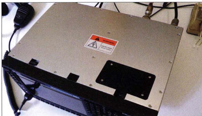
Bild 3: Unter der oberen Gehäuseabdeckung befindet sich die komplett geschirmte PC-Einheit.
