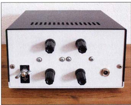
Bild 5: Nach dem Umbau des MFJ-835 befinden sich unten die Eingangs- und oben die Ausgangsbuchsen zum Einschleifen in die Zweidrahtleitung. Die 13,8-V-Hohlsteckerbuchse für die Instrumentenbeleuchtung ist rechts und der zusätzliche Erdungsanschluss links angeordnet. Fotos: DF2BC
