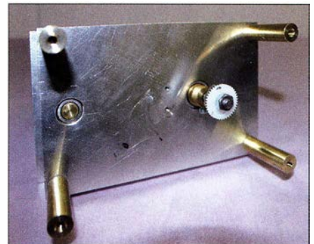
Bild 4: Das Zahnrad auf der Rotorwelle dient zum Antrieb des Potenziometers.
