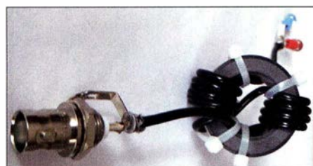
Bild 3: Foto eines Baluns mit Ringkern und Koaxialkabel RG174
