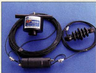
EFW80C10 mit 64:1-Unun am Einspeisepunkt und Verlängerungsspule für 80 m kurz vor dem entgegengesetzten Ende
