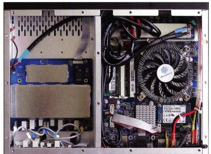
Bild 3: Unter der oberen Gehäuseabdeckung befindet sich die komplett geschirmte PC-Einheit.
