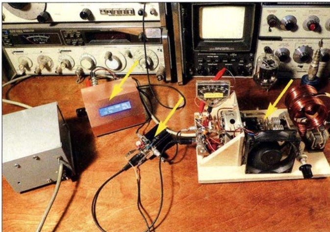
Bild 1: Eigenbau-CW-Sender mit seinen Baugruppen DDS-VFO, Treiberverstärker und Endstufe (v. l. n. r.), hier noch auf dem Messtisch der Werkstatt
