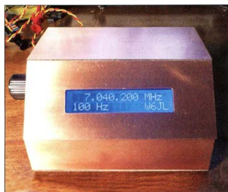
Bild 12: Steueroszillator des Senders; auf der linken Gehäusesseite ist der Einstellknopf für die Frequenz zu sehen. Das Display zeigt Ausgangsfrequenz und Schrittweite an.
